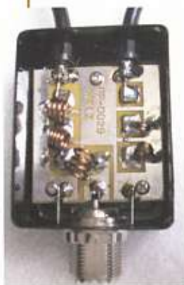
Duplexer voor middelgroot vermogen (100 W HF/VHF, 50 W UHF, vswr<1.2)
